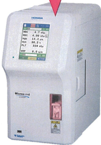
自動血球計数CRP測定装置 Microsemi LC-767CRP 製造販売届出番号: 26B3X00002230006 製造販売業者: 榑堀場製作所
